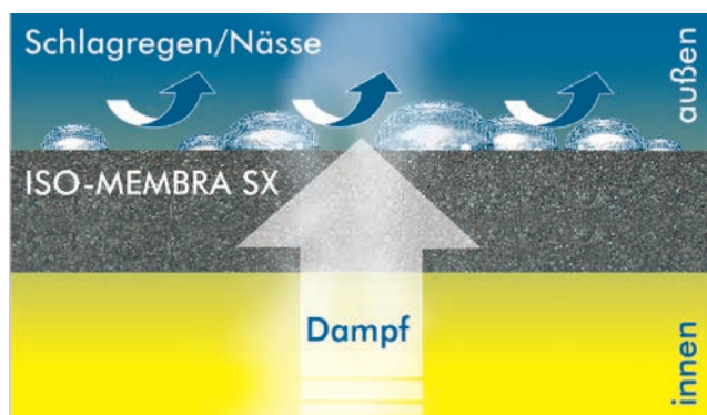
Wirkungsprinzip Dichtmembrane
